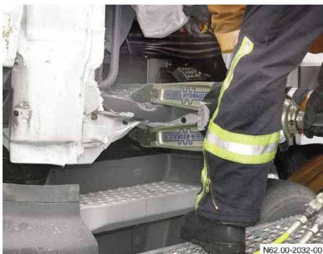
Zusammendrücken des Schwellers
