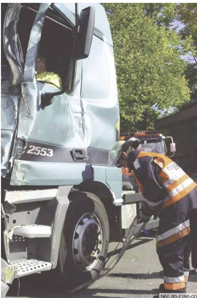
Spanngurt um Rahmen und Fahrerhaus
