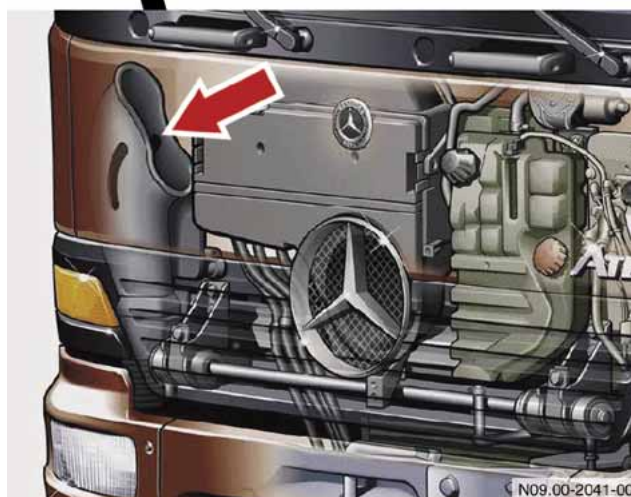
Einspritzstelle CO 2 (Pfeil) der Luftansaugung
