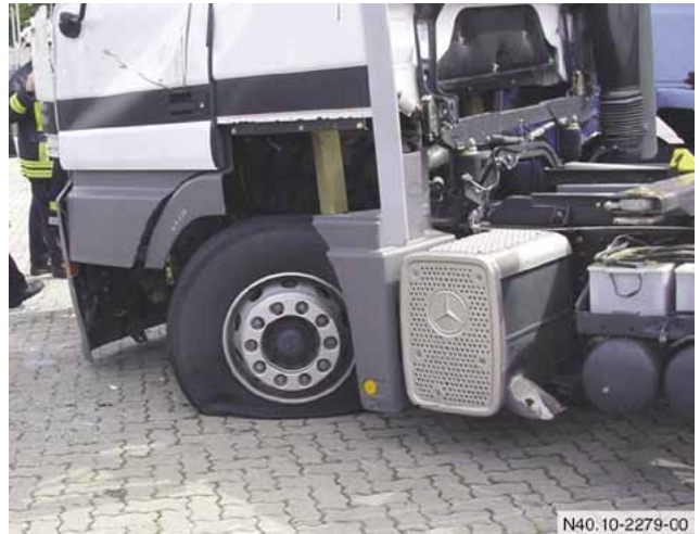
Zum Entlüften des Reifens Ventil herausschrauben
