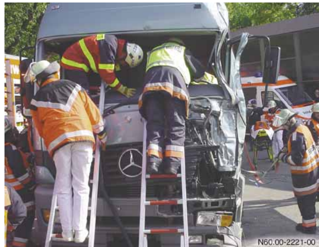
Einstieg über Steckleiterteil
