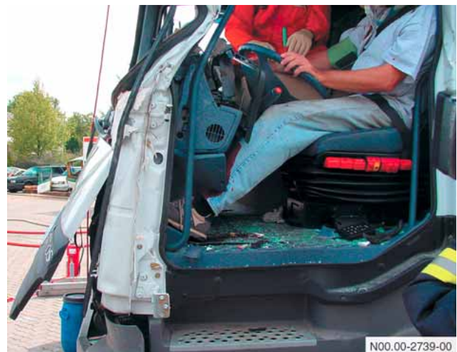
Deformierter Fußraum (Rettungsübung Ludwigshafen 15.09.2001)
