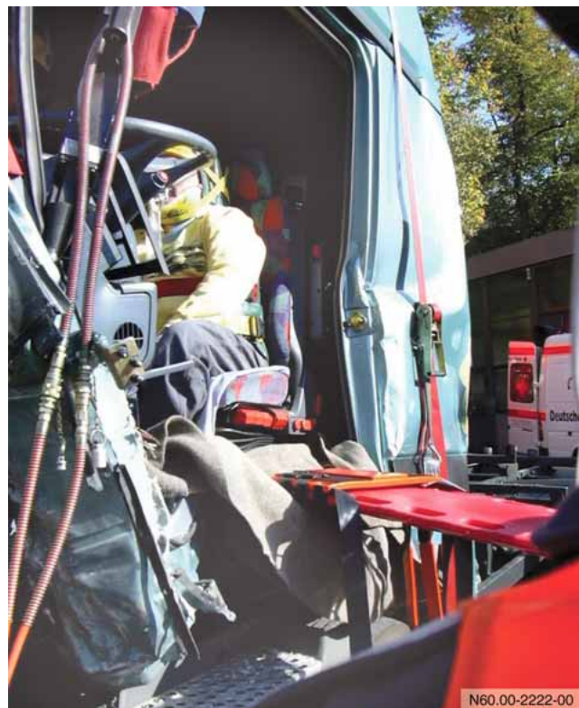
Befreiungsöffnung über die Fahrertür
