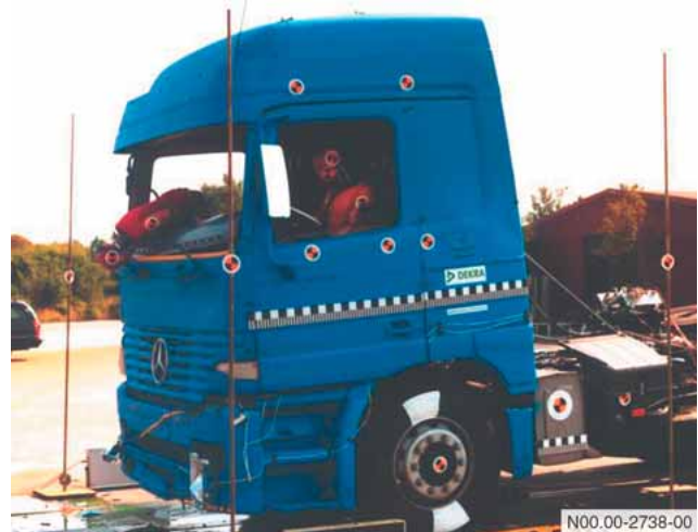
Fahrer angeschnallt, Beifahrer nicht angeschnallt. Aufprall mit 30 km/h auf Pritschenattrappe
