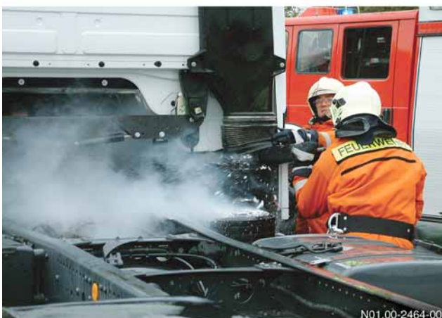
Einblasen von CO 2 in die Luftansaugung
